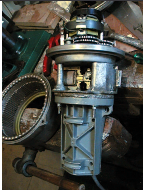
HAM-3: Hier ist gut der Unterschied zwischen Rotoren mit und ohne Bremse zu sehen. Das Unterteil beherbergt ein Relais, welches die Bremsnase heranzieht. Links im Bild die dazugehörige untere Abdeckung mit den "Spaltenkranz"
